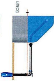
Principe d'aspiration d'un poteau d'aspiration à réseau sec
